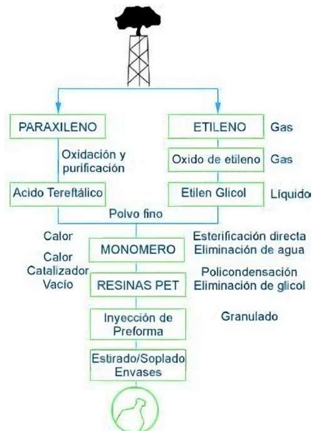
Fig. 2.14 Proceso de obtención del PET
